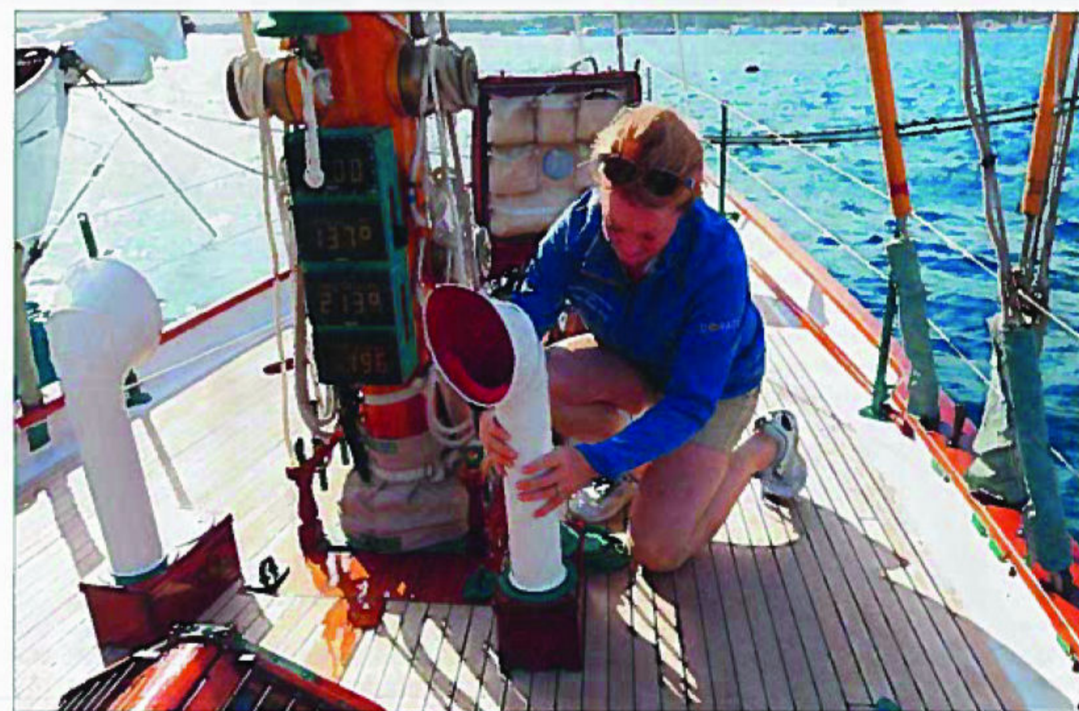
▲ Pas question de naviguer avec les immenses dorades de Dorada , solidaires de boîtes mises au point par Rod Stephens. Avant de quitter le quai, Pam Brooks, l'épouse du propriétaire, les dévisse puis les range soigneusement dans des housses qui iront rejoindre le carré.
