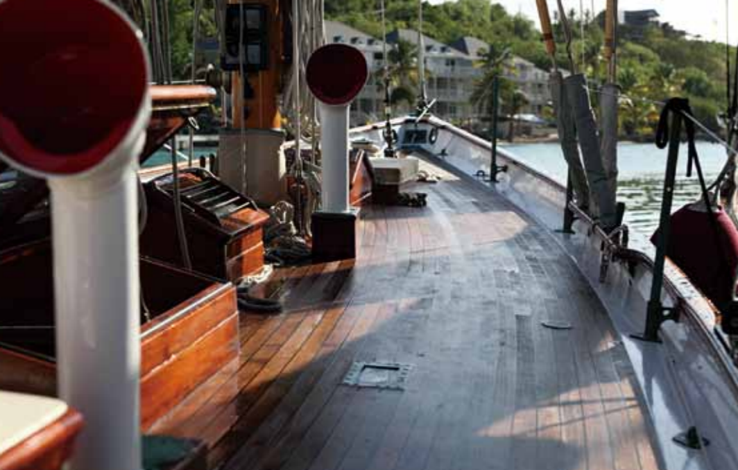
〈ドレイド〉のデッキ回り。2本見えるベンチレーターが「ドレイド・ベンチレーター」または「ドレイド・ボックス」だ
