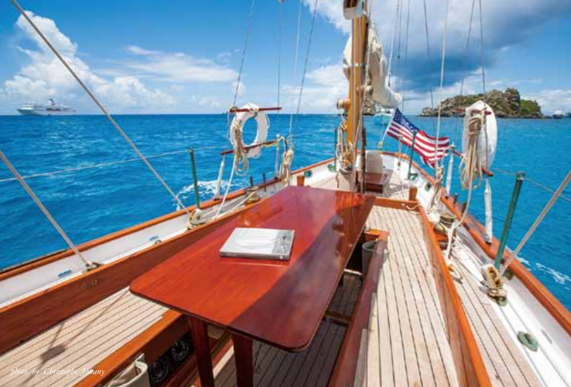
左：ここがコクピットに相当するところ。セットされているテーブルを外すと、中央付近にティラーが現れる 右：メインキャビンからスターン方向を見たところ。ポートサイズ53ftに対して、細身の船型が分かる
