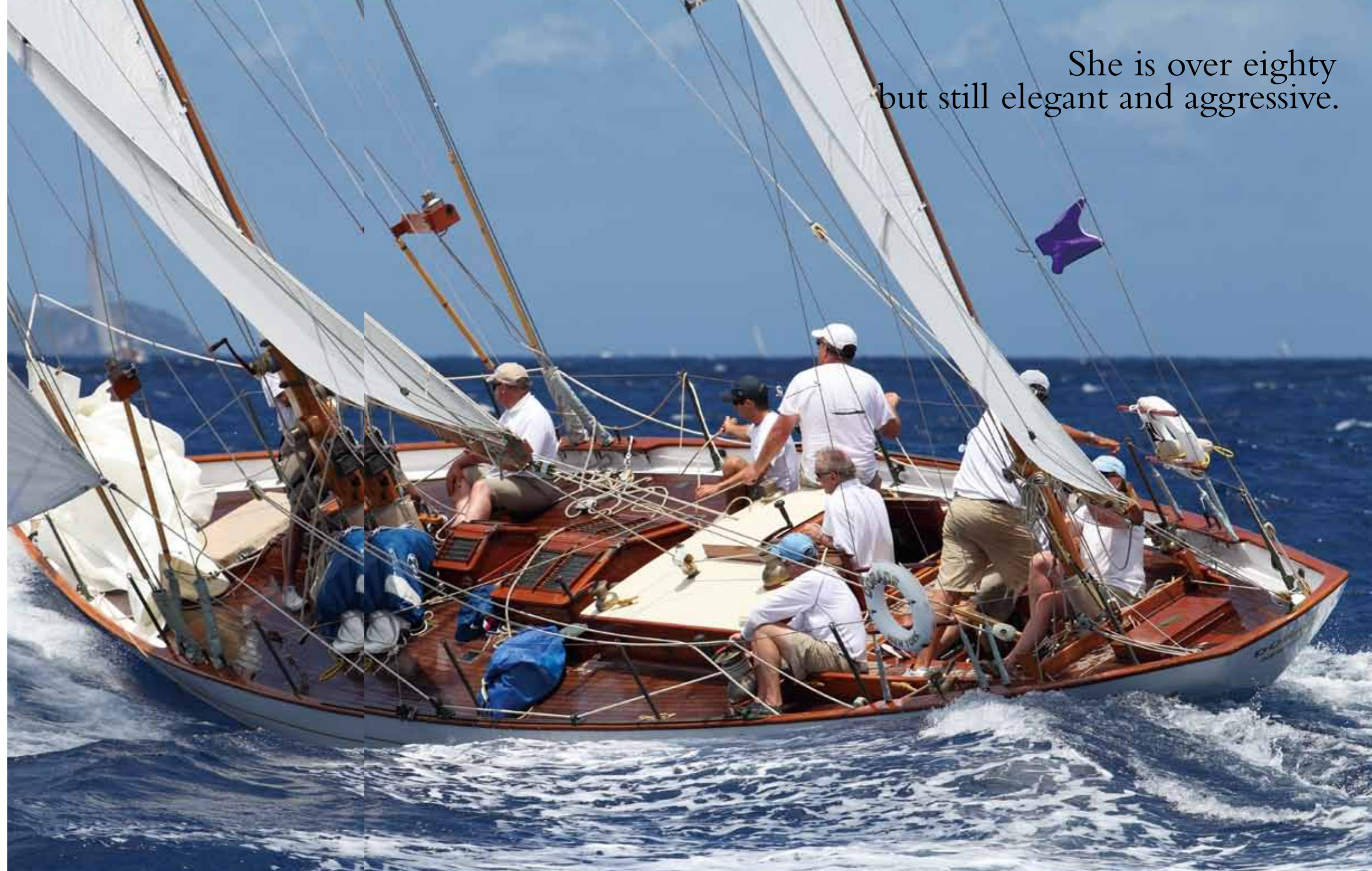
〈ドレイド〉のデッキ回り。2本見えるベンチレーターが「ドレイド・ベンチレーター」または「ドレイド・ボックス」だ
