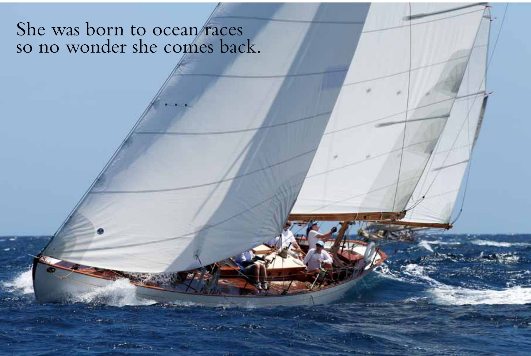
全長52.6ftに対して全幅10.3ftと細長いが、よく浮いていて波にも強そうだ
