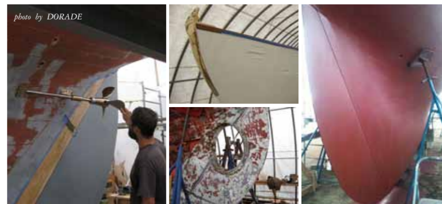
〈ドレイド〉のディーキールは、特に底部に重量物を配したものだ。今回のレストアではプロペラアパーチャーがあったものを塞いだことがわかる。またパウは典型的なスプーンタイプだ
