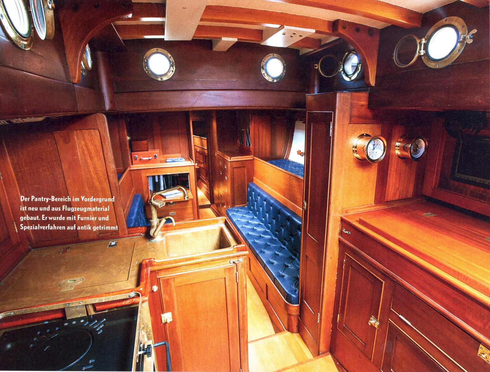
Der Pantry-Bereich im Vordergrund ist neu und aus Flugzeugmaterial gebaut. Er wurde mit Furnier und Spezialverfahren auf antik getrimmt
